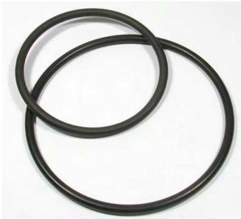
Ersatz O-Ringe Durchmesser der Viton-Schnur ist 5.3mm für alle Größen bis 250 ISO-K und 7mm bei alle größeren Flanschen
