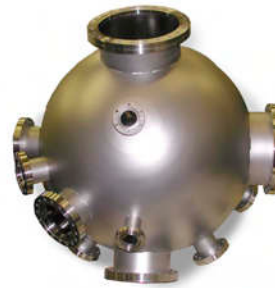
Kugel-Kammern werden hergestellt aus gedrückten Edelstahl-Halbschalen - eine typische Bauform für die Oberflächenforschung
