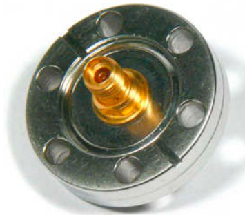
Vakuumseite der 40 GHz Durchführung auf einem 16CF-Flansch
