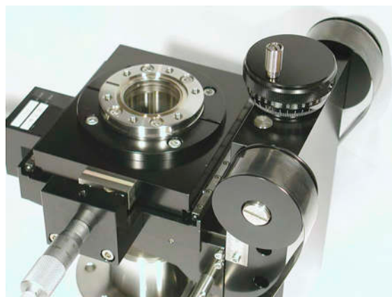
Detail eines Manipulators mit zusätzlichen Federn zur Entlastung
